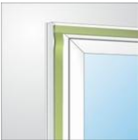
Bild 1: Eckauslegung bei der Fenstermontage
