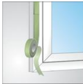
Ilustracja 2: Sposób połączenia dwóch końców taśmy.
