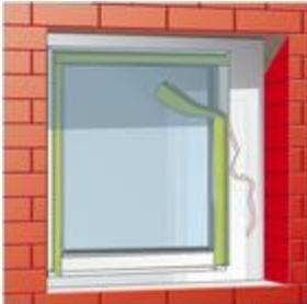
Bild 1: TP601 mit der Selbstklebung am Fensterrahmen fixieren.
