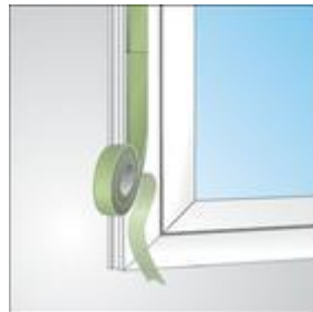
Bild 3: Stumpfstoss bei der Fenstermontage
