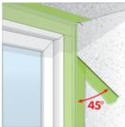
Bild 3: Überstehende Folie mit dem Reißfaden unter 45° abreißen.
