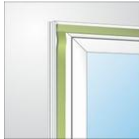
Bild 1: Bandverlegung bei der Fenstermontage
