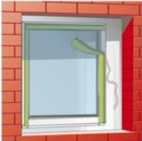
Bild 1: TP601 mit der Selbstklebung am Fensterrahmen fixieren.
