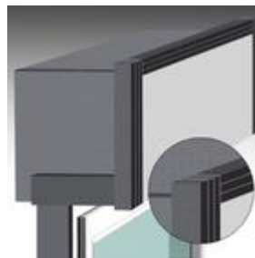
Bild 3: Band senkrecht auf die Kopfstücke kleben
