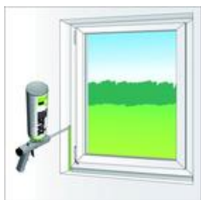
Ilustracja 3: Wypełnić pianką fugę okienną
