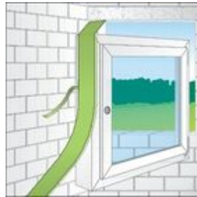
Bild 1: Verklebung mit dem angrenzenden Baukörper
