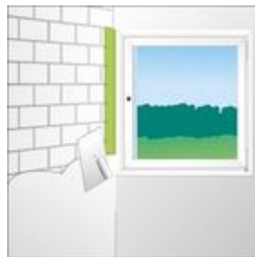
Bild 2: Überputzen der Vliesseite
