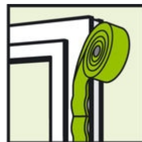
Colocación de TP610 para posterior aplicación de la espuma PU elástica FM330
