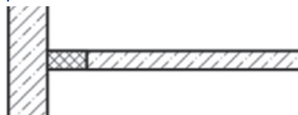
Junta horizontal contra una pared
