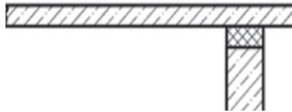
Junta entre muro y forjado
